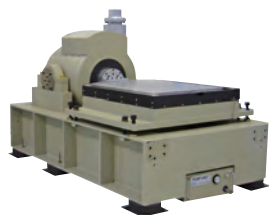
【水平 / 垂直切換式振動試験装置】 加振力 35kN 大ストローク
