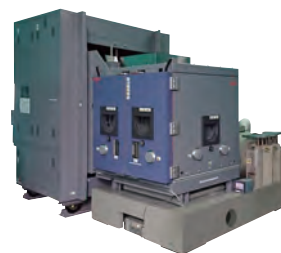
【水平 / 垂直切換式複合試験装置】 加振力 40kN(テーブル寸法 800mm) 温度範囲：-70 ~ 200℃仕様(湿度付き)
