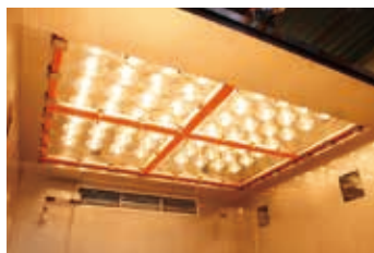
赤外線照射ランプ付温(湿)度試験槽部(試験物収納部)
