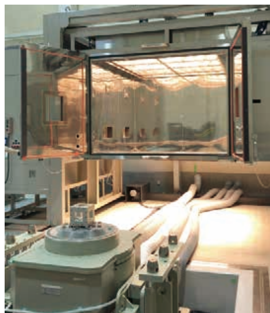
赤外線照射ランプ付温(湿)度試験槽部(試験物収納部)
