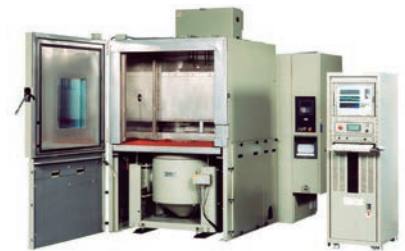
※振動制御装置は、コンソールラック・マウント方式です。(オプション)
