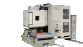
40kNクラス垂直水平複合環境試験装置
