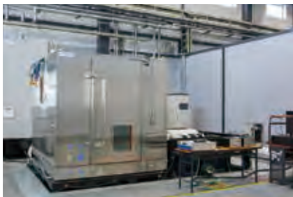
200kN 大型复合环境试验装置
