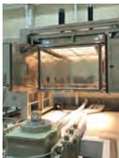
带红外线照射灯的温湿度试验槽部分
