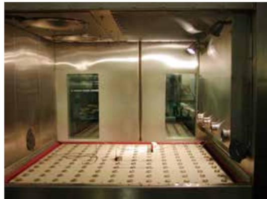
HALT/HASS试验装置是为了及早地发现产品的缺陷，在产品开发过程中，施加振动和温度，以及加上其他复合条件的极限应力，以及在设计时尽快地反映出来而开发的评估装置。
