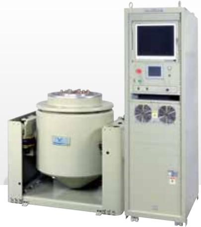
在“冲击脉冲作用时间为11ms, 加速度为980m/s<sup>2</sup> (100G)”的试验条件下进行试验时使用的振动试验装置。
