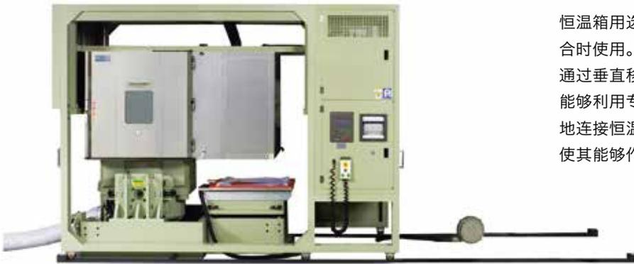
恒温箱用选件与附属有水平振动台的振动试验装置进行组合时使用。
